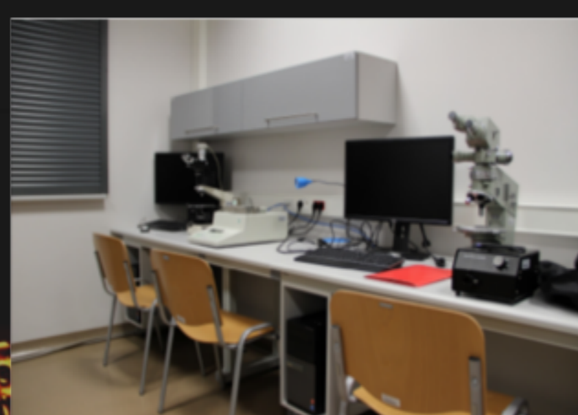
Rysunek 2. Zdjęcie układu doświadczenia użytego do badania przejść fazowych metodą mikroskopii polaryzacyjnej, źródło [5]
