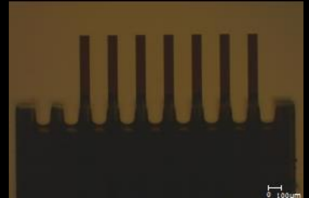
Rys. 3. Zdjęcie mikrobeleczek wykonane przy 40-krotnym powiększeniu w mikroskopie optycznym.
