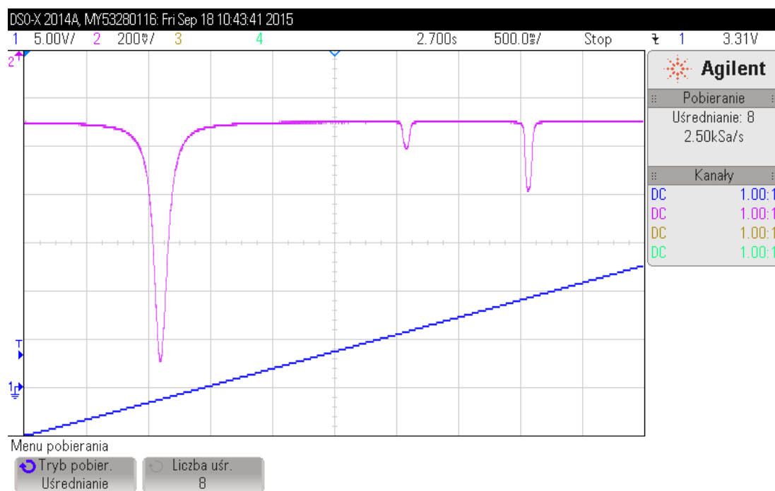
Rys. 11. Rezonans w polu zerowym i rezonanse od pola RF dla małych wartości pola magnetycznego.
